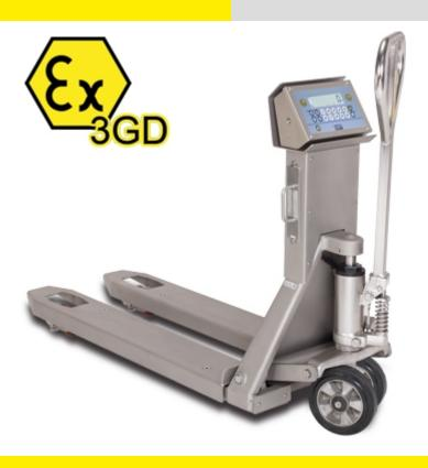
Transpalette manuel avec électronique de pesage pour zones dangereuses classées à risques d'explosions (zone 2 et 22) selon les normes ATEX Ex II 3GD IIC T6 T130°C X. Equipé de 4 capteurs ATEX en acier INOX étanches IP68, garantissant une précision dans toutes les conditions de travail. Structure entièrement en acier inoxydable. Disponible également en UR pour la transaction commerciale CE-M.
