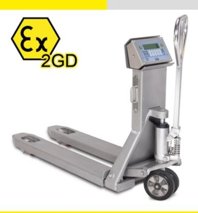
Transpalette manuel avec électronique de pesage pour zones dangereuses classées à risques d'explosions (ZONES 1 et 21 & 2 et 22) selon les normes ATEX Ex II 2GD IIB T4 T197°C X. Equipé de 4 capteurs ATEX en acier INOX étanches IP68, garantissant une précision dans toutes les conditions de travail. Structure entièrement en acier inoxydable.
