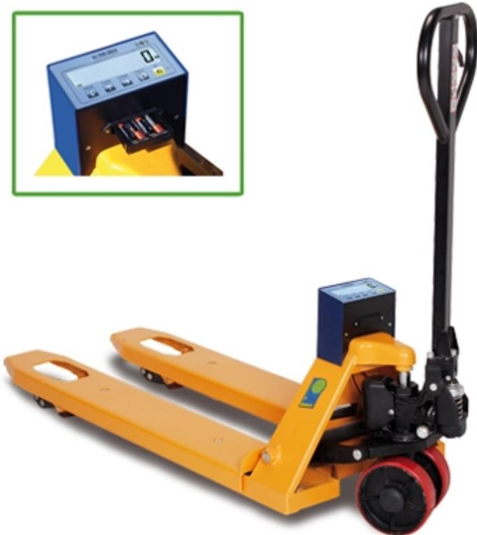
Transpalette manuel avec électronique de pesage, facile à utiliser et à manipuler. Equipé de 4 capteurs cisaillements pour le maximum de précision pendant le pesage. Un indicateur de poids avec une grand afficheur LCD rétro éclairé pour une bonne lecture dans toutes les conditions de travail. Disponible également en version avec télécommande.
